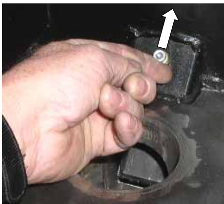
Abb. 116: Repetierhebel nach oben drücken!
