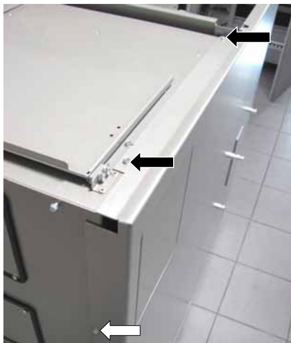
Abb. 18: Demontage Seitenverkleidung ivo.safe ®
