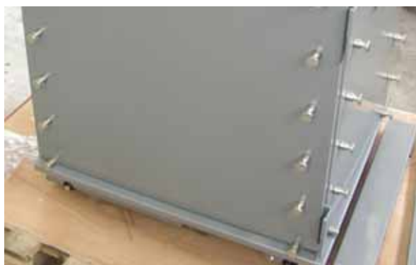
Abb. 28: Verkleidung mit eingeschraubten Bolzen und Schrauben
