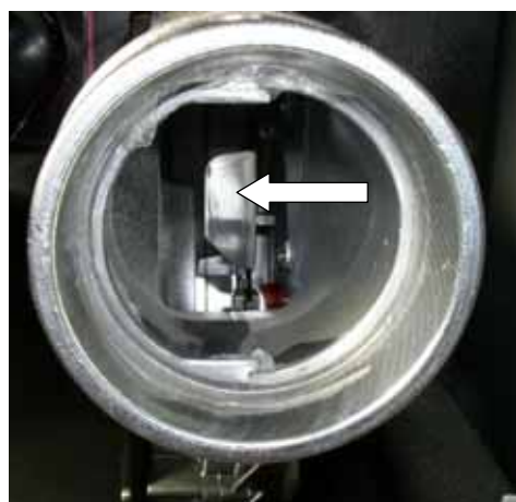
Abb. 142: Abluftstutzen mit Flügelrad
