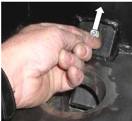
Abb. 111: Repetierhebel nach oben drücken!
