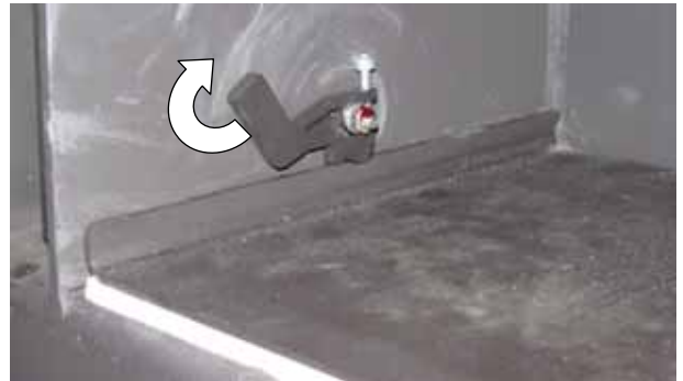
Abb. 106: Arretierung Abdeckplatte geschlossen
