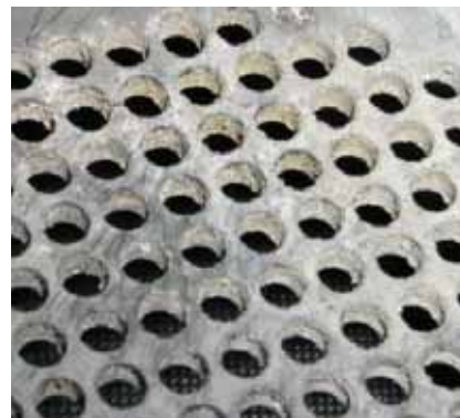
Abb. 122: Schwenkrost richtig gereinigt
