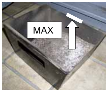
Abb. 91: Maximaler Füllstand Aschelade
