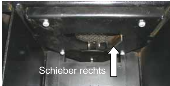
Abb. 89: Rost geschlossen (Position RG)
