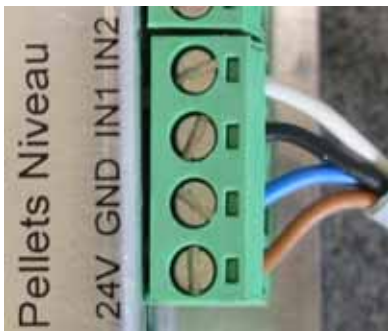
Abb. 64: Elektrischer Anschluss Pellets Niveau
