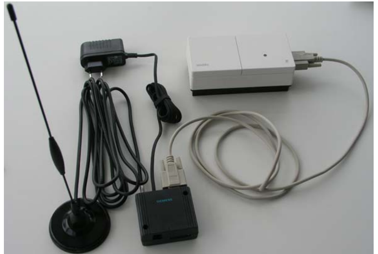
Verkabelung mit der C-Box 1
