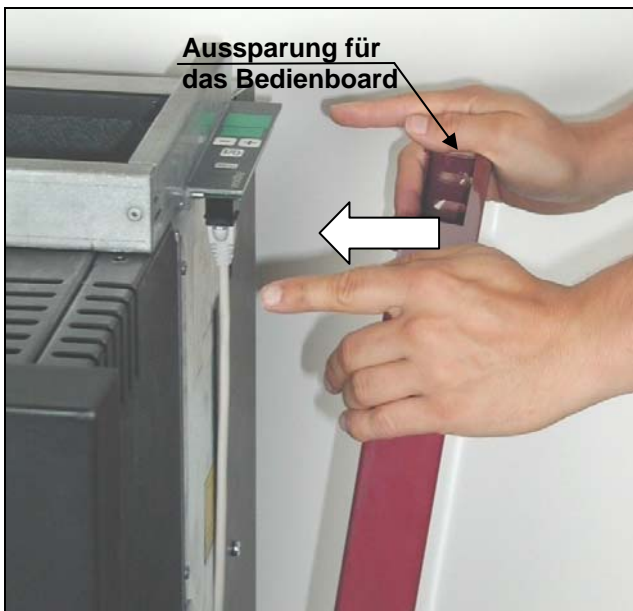
Abb. 11: Seitenteil unten einhängen und an die Behälterwand anlehnen.
