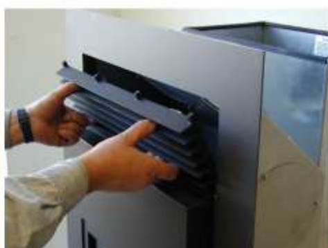
Frontgitter abschrauben und entfernen.
