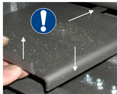
Fig. 35 Position de montage Tenir compte des renvois en acier : pliage vers le haut à l'avant, pliage vers le bas sur les côtés, languette vers l'arrière.
