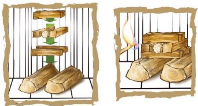
Fig. 26 : allumage correct (source HKI)
