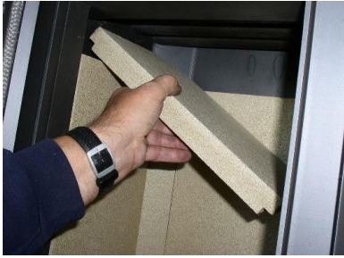
Fig. 37 : démontage du déflecteur
