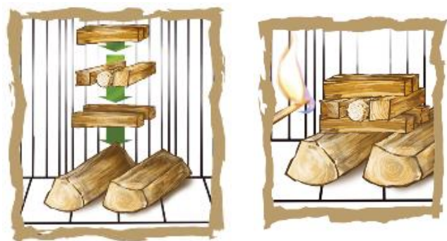
Fig. 17 : allumage correct (source HKI)
