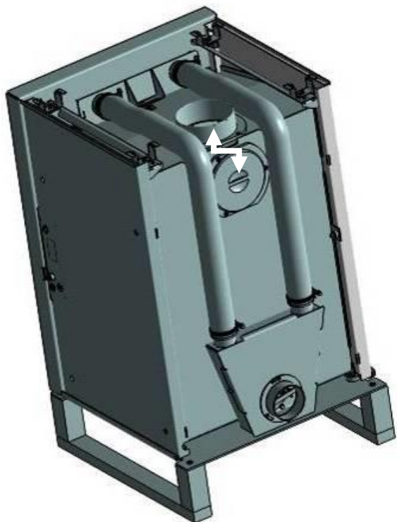
Fig. 14 Remplacement du raccord du tuyau de fumée
