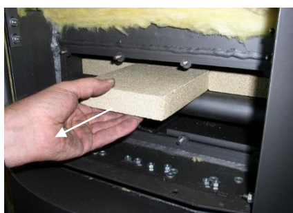
Fig. 29 Retirez les 3 déflecteurs supérieurs
