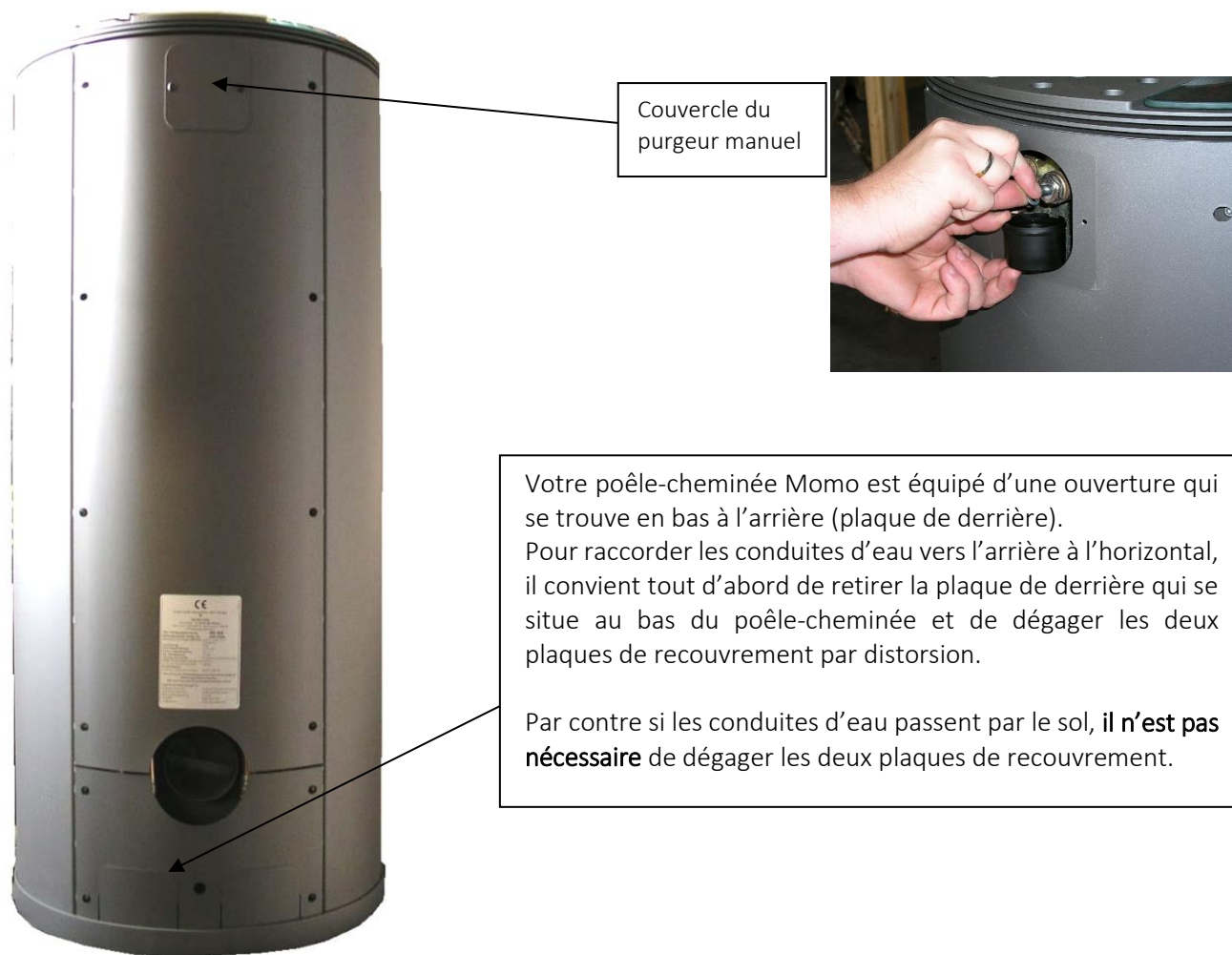
Fig. 8 Position du purgeur manuel et possibilité de découpe pour le raccordement hydraulique horizontal
