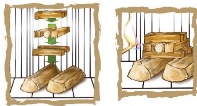
Fig. 19 : allumage correct (source HKI)
