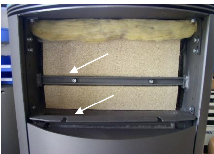
Fig. 27 Retirez les plaques de protection thermique
