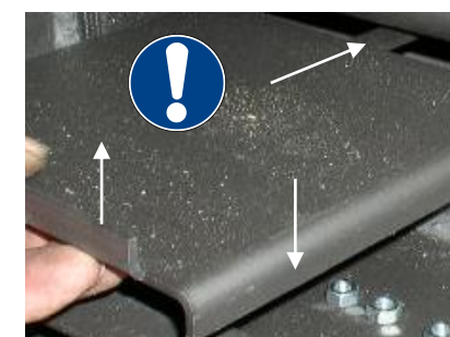
Fig. 31 Attention à la position de montage des déflecteurs en acier: Arête antérieure vers le haut, Arête latérale vers le bas, languette vers l'arrière
