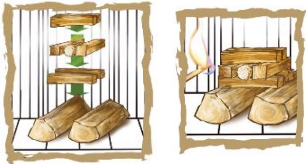
Fig. 27 : allumage correct (source HKI)
