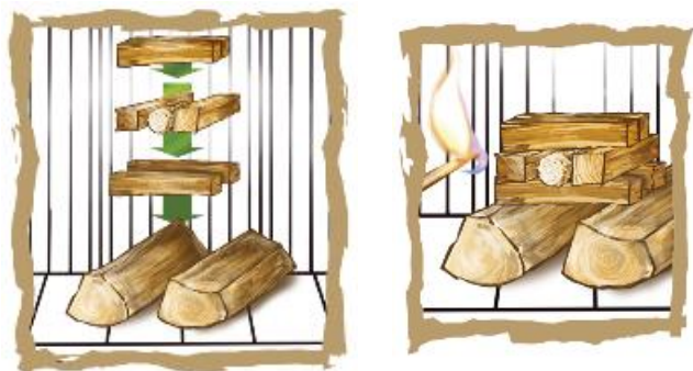
Fig. 17 : allumage correct (source HKI)
