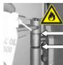
Fig. 12 : huiler le mécanisme de la porte
