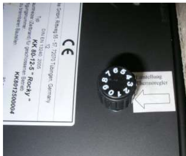
Fig. 11 : molette de réglage du thermorégulateur - vue par l'avant
