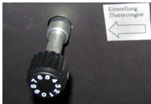
Fig. 23: Régulateur thermique sur réglage de base
