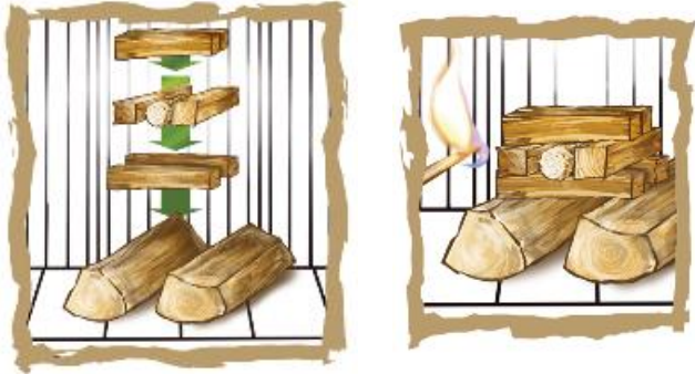
Fig. 8 : allumage correct (source HKI)
