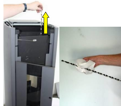
Fig. 85 : retrait et nettoyage turbulateur
