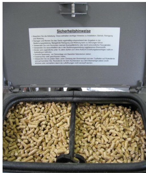
Fig. 63 : réservoir à pellets plein
