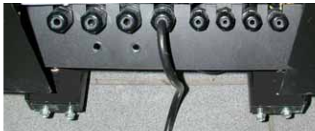
Barre de raccordement centrale (raccordements PG / décharge de traction) pour des raccordements externe et la fiche secteur (arrière, inférieur)
