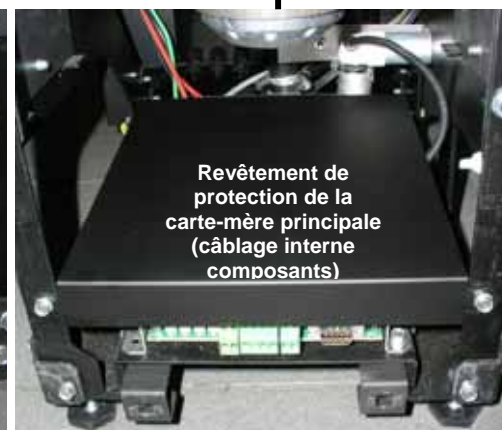
Raccordements avant de carte-mère principale
