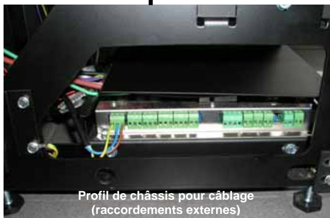
Raccordements latéraux de carte-mère principale
