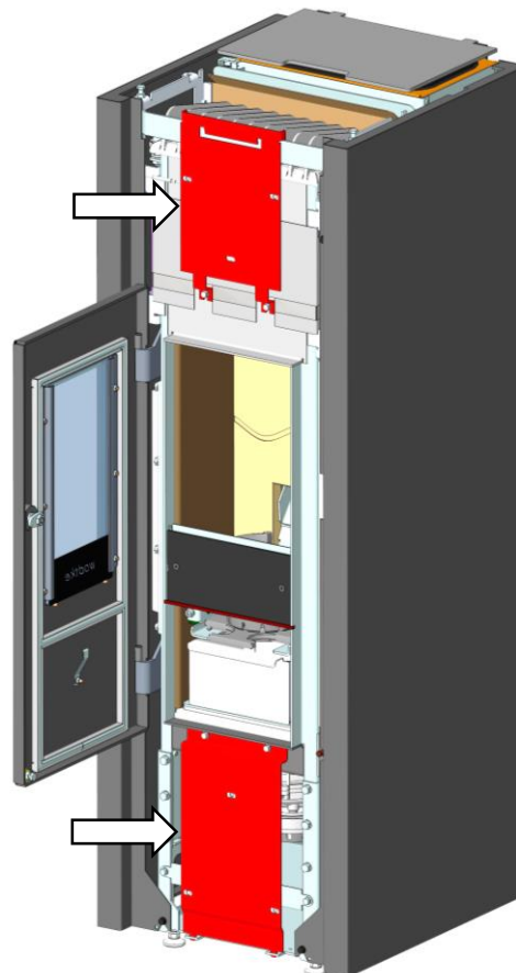
Fig. 3: brides de support des habillages avant
